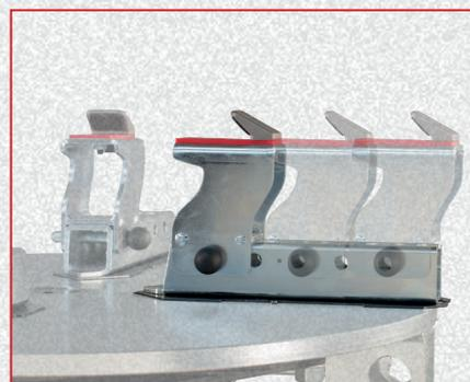
Le système de blocage est équipé de protections en plastique pour éviter les éraflures sur les jantes.
